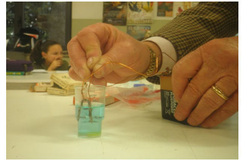
L'esperimento di elettrodeposizione del rame cambretta di ferro.
